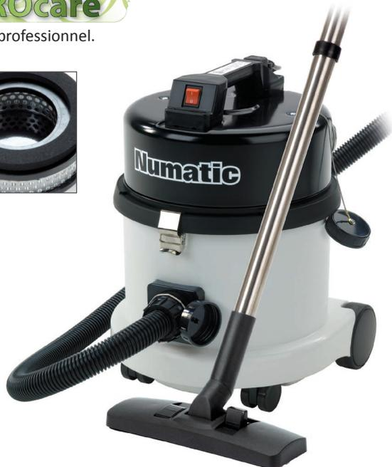
Aspirateur compact qui répond aux spécifications ISO 5 classe 100 spécial salles blanches (ISO 14644-1). La conception de cette double filtration HEPA (avant et après moteur) fournit un niveau de filtration certifiée ISO 5 classe 100 (ISO14644-1) sans perte de puissance ou de performance. Bouchons de sécurité, système NUPLUG pour permettre le remplacement rapide et sans outil du câble.
