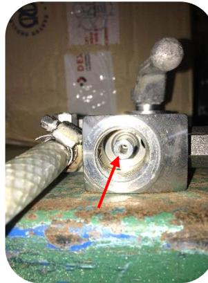
**4** – Visualiser l'injecteur situé à l'intérieur de l'appareil.
