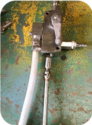
**5** – Insérer une clé à douille 8mm afin de dévisser l'injecteur.
