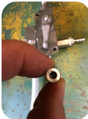
**8** – Vérifier que l'injecteur n'est pas obstrué ; procéder aux remplacements nécessaires (injecteur et joints) puis effectuer le remontage (procédure inverse).
